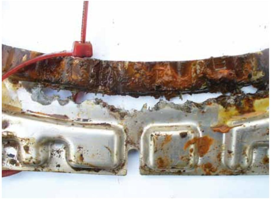
Typischer Befall einer Platte – eine für MIC charakteristische, weiche, schleimige Foulingschicht
